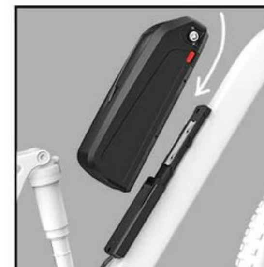
3- Encaixe a bateria na base
